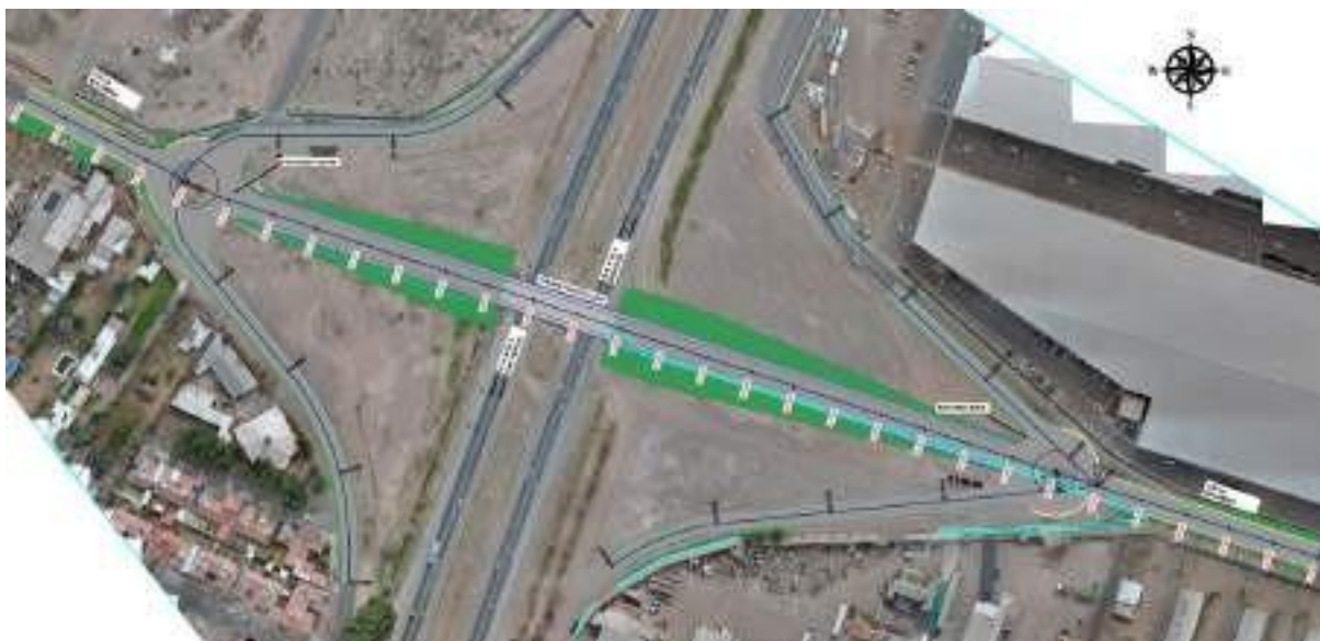
Imagen 21 Propuesta de intervención en intersección RN N°40 y calle Malabia. Fuente: Elaboración propia. Año: 2025.
