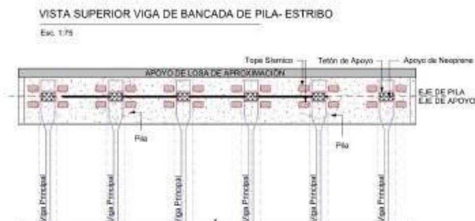
Imagen 37. Vista superior de viga bancada de pilas y disposición de los apoyos, placas de neopreno y topes sísmicos puente Malabía y Zapóla
